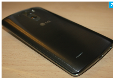
Рис. 3. Клавиши управления находятся сзади. Там же расположен и лазерный автофокус камеры
